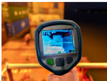
Wärmebildkamera. Das Display zeigt an, in welchen Schiffsbereichen kritische Temperaturen herrschen.
